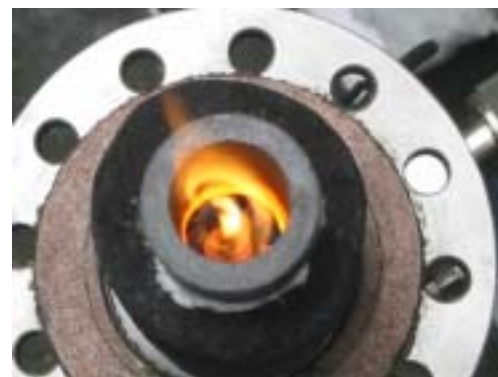
ミキシングの悪い状態
