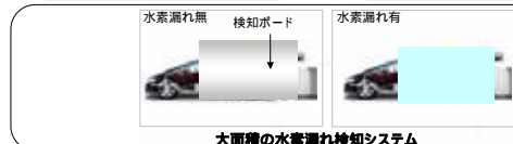
大面積の水素漏れ検知システム
