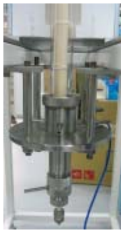
三重管式試験装置下部支持機構
