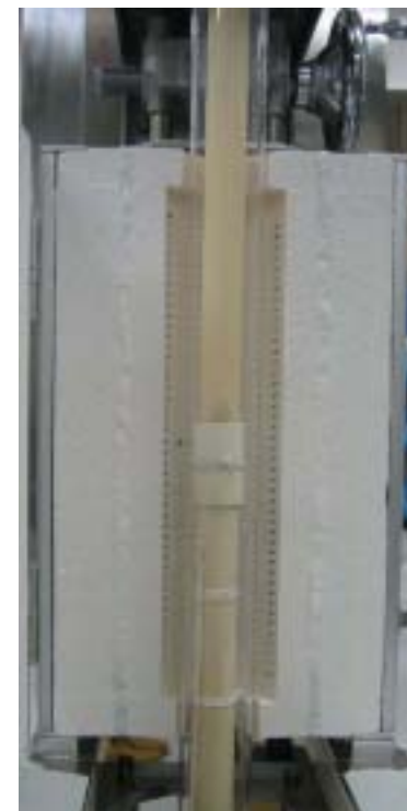
三重管式試験装置電気炉部
