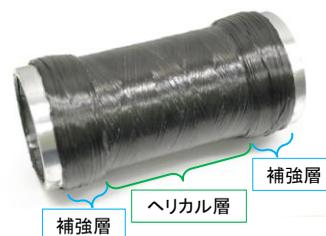
上記のDRY法(4種)、WET法(1種)をそれぞれ内部加熱成形と従来成形を組み合わせ計10種の試験片を製作し、破裂圧力の測定を行う
