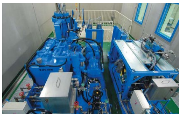
破裂試験 343MPa
