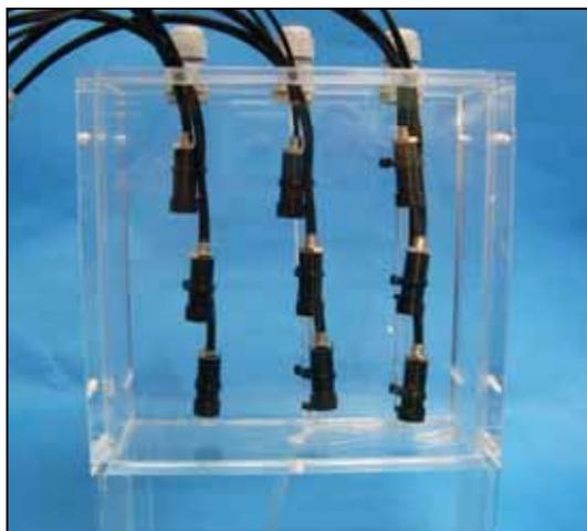
実験用チャンバーおよび多点システム計測点
