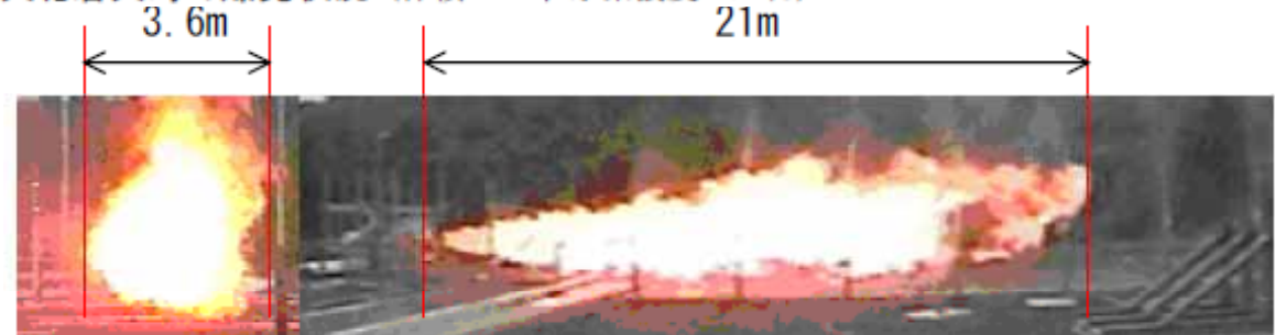
図C. 4. 2-2 燃焼状況 (d=10mm、P=28MPa) (Naによる炎色反応で着色)
