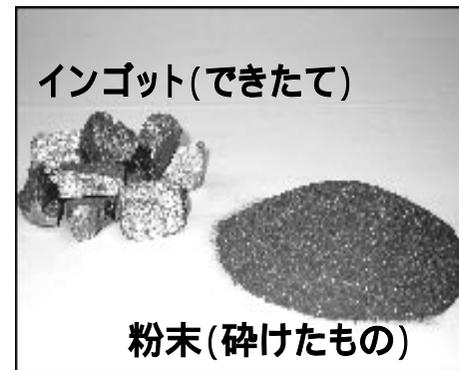
5kW級水素システムで使用している合金は、AB5系合金
