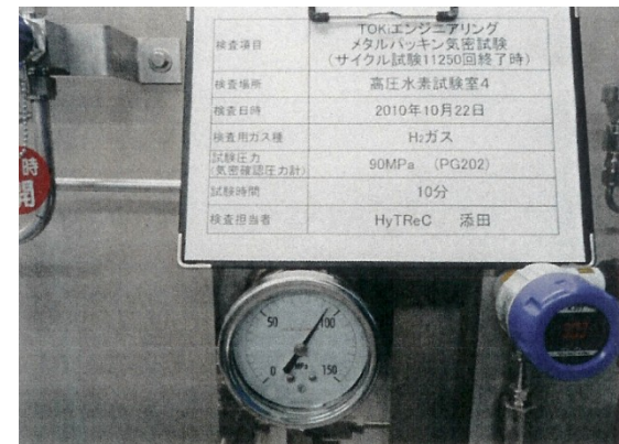
気密試験(水素ガス, 90MPa, 11250回後)
