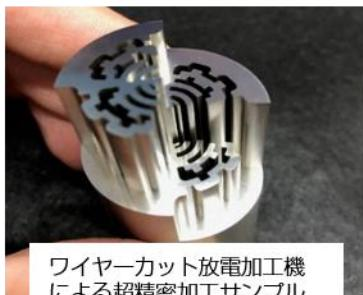
ワイヤーカット放電加工機による超精密加工サンプル
