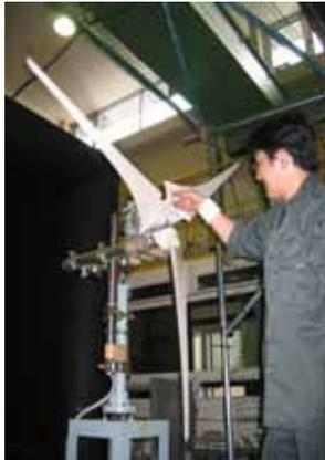
試作風車の風洞実験
