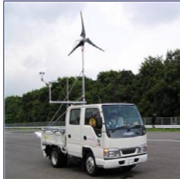
産総研周回路を使用したプロトタイプ風車の性能・機能試験
