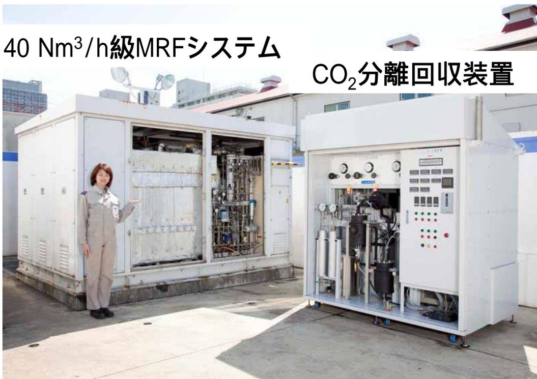
MRFシステムとCO<sub>2</sub>分離回収装置
