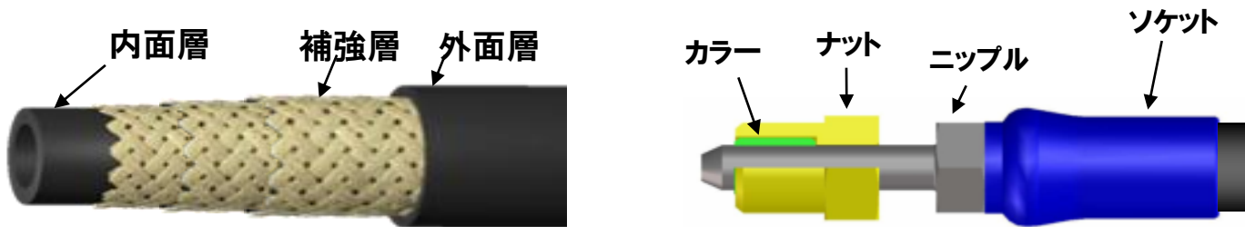
70MPa級ホースの構造 及び 金具の形状
