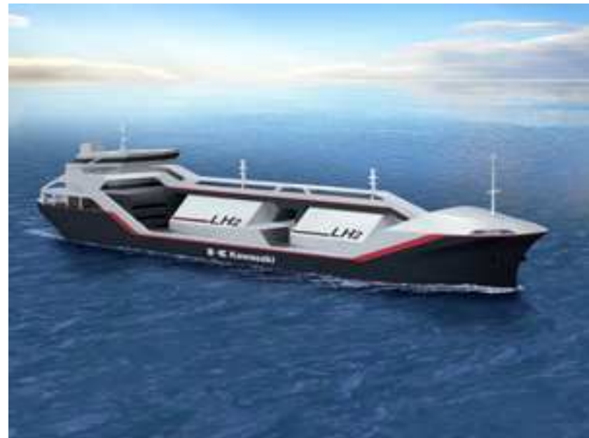
液化水素運搬船 (貨物総容積:2,500m 3 )
