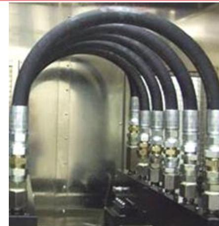
✓ 82MPa<sup>h</sup>-s条件での耐久性良好 ⇒ 試験条件の標準化検討とともに耐久性評価を継続実施
