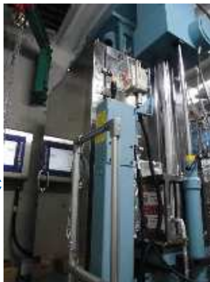
300°C, 140MPa水素ガス 油圧サーボ試験機 (H26年度末導入)
