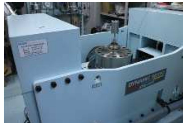
300°C, 140MPa水素ガス 共振疲労試験機 (H26年度末導入)
